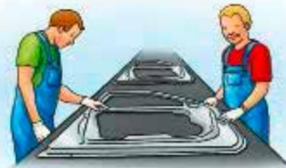
Arbeiter überprüfen, ob die gepressten Bleche keine Fehler oder Schäden haben.
